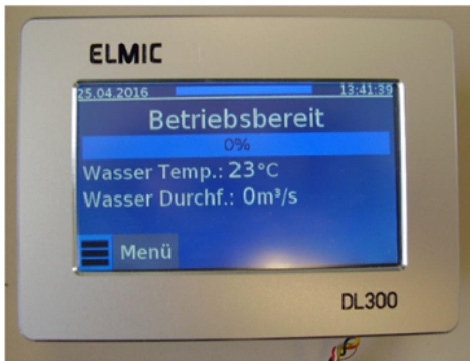
Kleines Display mit 4,3" Diagonale, Einbaurahmen 130 x 94mm
